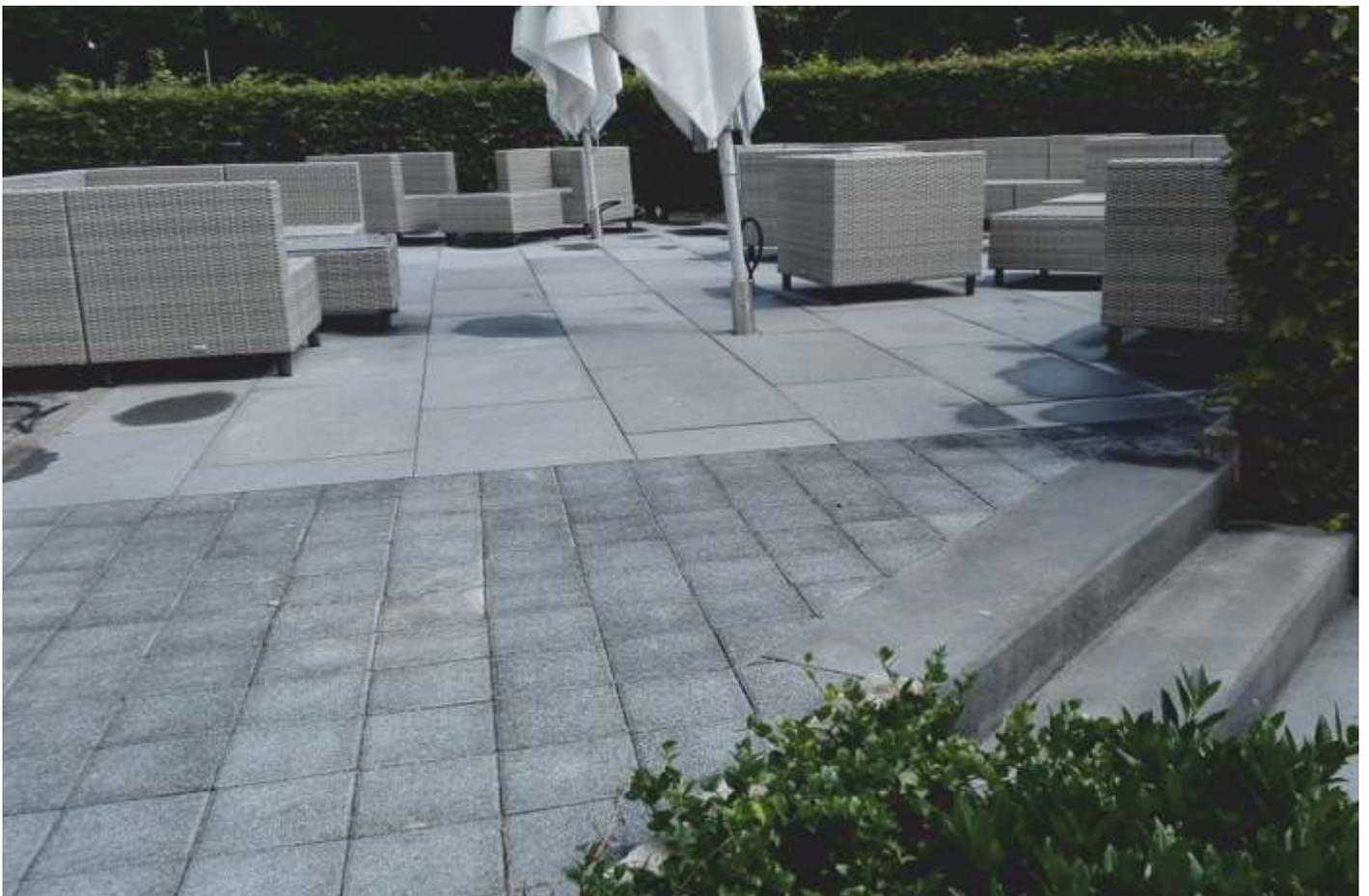
Kombination aus La-Strada Maxi-Großplatten 120/60/4 cm im Farbton Granit-anthrazit mit La-Strada Pflaster 20/20/8 cm mit Fase in Basalt-brilliant und STRAHLIT - Blockstufen 15/35/100 cm in anthrazit
