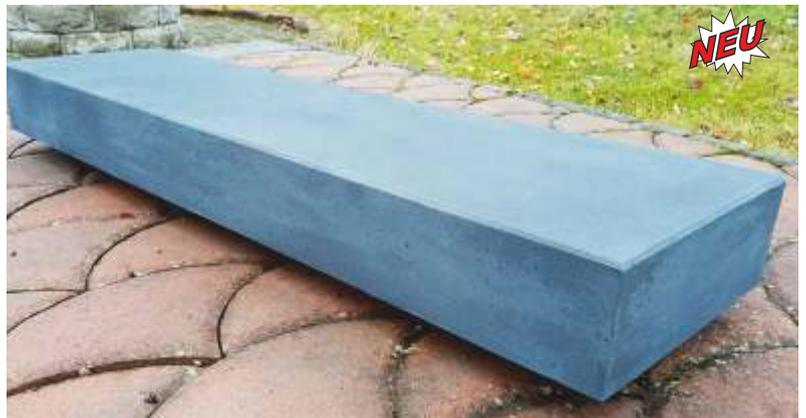
Die neuen Stufen 15/40 aus unserem Werk in Troisdorf weisen eine Rutschfestigkeit von R 13 auf und sind durch die dicht geschlossene Oberfläche weniger anfällig gegen Verschmutzungen. Durch eine werkseitige Hydrophobierung verringern wir die für anthrazit-farbene Sichtbetonteile nicht zu vermeidenden Ausblühungen. Alle umlaufenden Seiten sind mit der rauen Oberfläche ausgeführt, was der Stufe eine besondere Optik verleiht.
