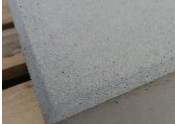
Rutschsichere Oberfläche (nach R13) unserer Architektenstufen in ruvido
